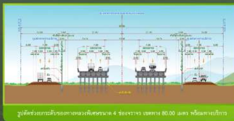
รูปตัดช่วงยกระดับของทางหลวงพิเศษขนาด 4 ช่องจราจร เขตทาง 50.00 เมตร
