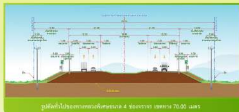
รูปตัดทั่วไปของทางหลวงพิเศษขนาด 4 ช่องจราจร เขตทาง 70.00 เมตร
